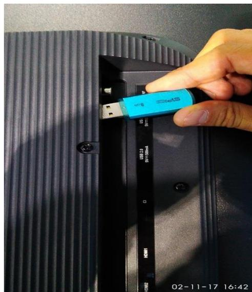
3. Для начала обновления ПО следует нажать на ПДУ ( пульт дистанционного управления) на кнопку MENUПерейти навкладку «Установка/Setup» «Обновление программы USB/Software update USB»Нажать на кнопку «OK» на ПДУ.
